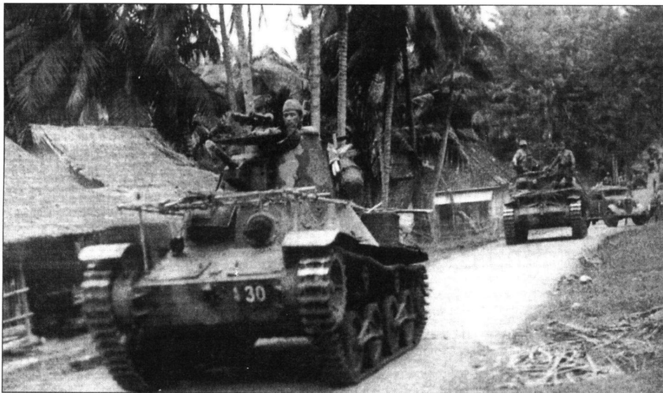
Легкий танк «тип 95 Ха-го» возглавляет японскую механизированную колонну, остров Ява. Второй в колонне - средний танк «тип 97 Чи-ха». Обратите внимание на бамбуковую раму, закрепленную на корпусе танка «Ха-го», рама служит для крепления маскировки.
