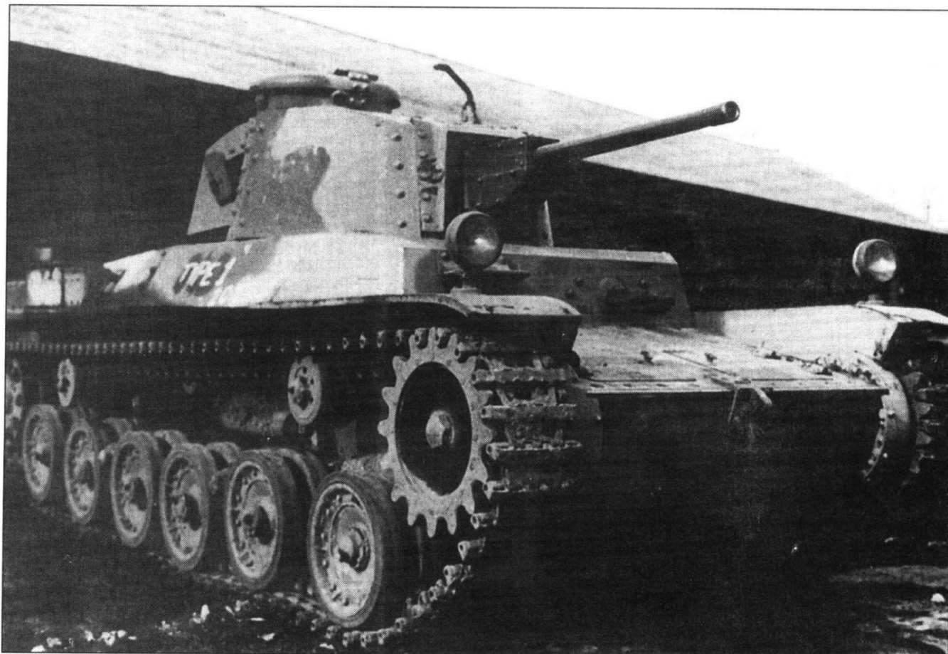
Вид 3/4 спереди на средний танк «тип 1 Чи-хе», эта машина представляла собой модернизированный вариант танка «тип 97 Шинхото Чи-ха». Обратите внимание на форму корпуса, решетки забора воздуха в бортах отсутствуют. Размеры башни увеличены.
