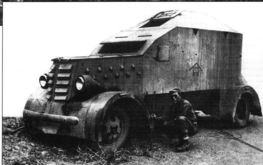
Импровизированный броневедомитель на шасси грузовика Форд-Т. Такие машины выпускались в Гонг-Конге. Машина была захвачена японцами после капитуляции города 25 декабря 1941 г. Прослужила новым хозяевам всю войну и опять вернулась к старым в сентябре 1945 г., когда машину отбили британские войска. Обратите внимание на тактический знак, изображенный на стенке кузова.
