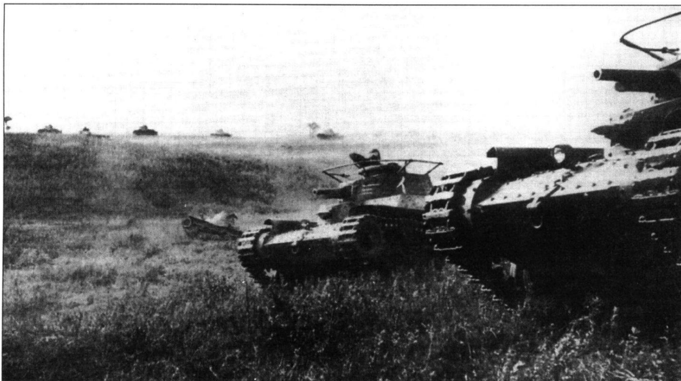
Штабной взвод танковой роты из 23-го танкового полка на учениях в Маньчжурии. Обратите внимание на поручневые радиостанции на среднем танке «тип 97 Чи-ха», на заднем плане - легкий танк «тип 95 Ха-го», также оснащенный радиостанцией.
