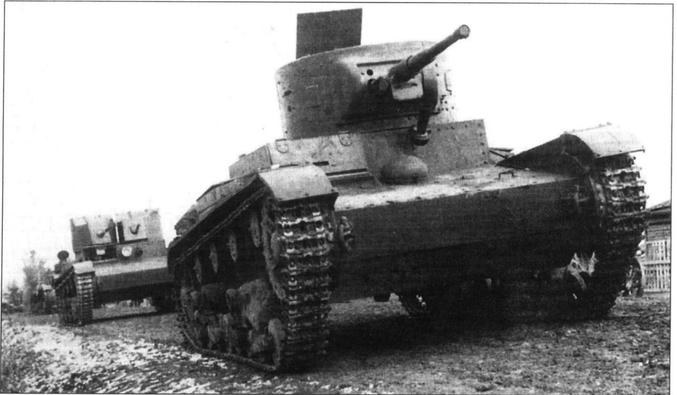
Легкий танк Т-26 образца 1933 г. От танков образца 1931 г. его легко отличить по цилиндрической башне с 45-мм орудием. На заднем плане - Т-26 образца 1931 г. Танки Т-26 представляли собой развитие британского танка Виккерс 6-тонный.
