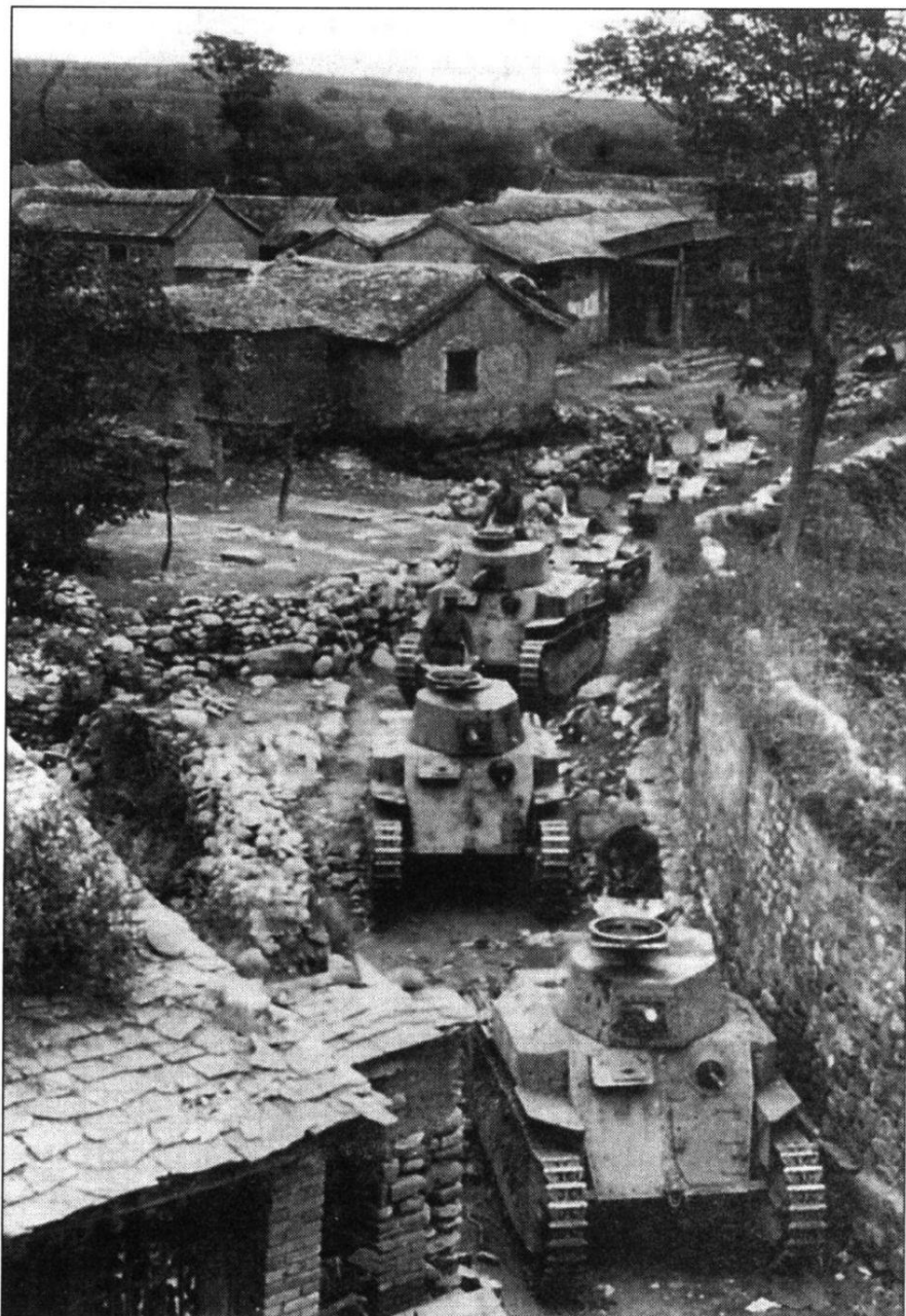
К 1942 г. танки «Чи-ро» устарели безнадежно, но тем не менее применялись на Филиппинах и в Китае. На снимке - три танка «тип 2594 Чи-ро» и танкетка «тип 94», Северный Китай.
