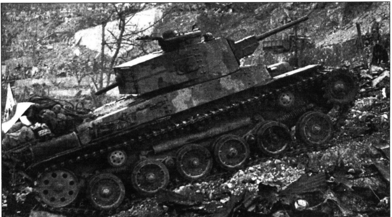
Вероятно этот снимок среднего танка «тип 97 Шинхото Чи-ха» сделан в 1944 г. в Бирме. На крыше башни виден наблюдательный прибор командира. Задняя створка верхнего башенного люка откинута. Из люка торчит верхняя часть головы командира танка в шлеме с очками. Вполне возможно, что танк идет в атаку - жалюзи закрыты бронеклопами.
