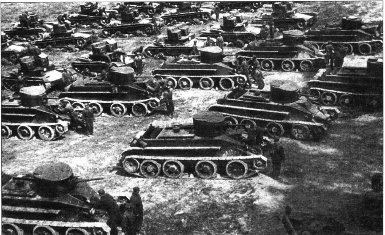
Танки Т-26 (на заднем плане) и БТ-2 механизированной бригады Красной Армии, учения 1933 г. Танки Т-26 образца 1933 г. имели одну башню с артиллерийским вооружением, а не две пулеметные, как танки на снимке. Именно однобашенные Т-26 составляли главную ударную силу советских танковых частей в боях на озере Хасан. Две пулеметные башни стояли на танках Т-26 образца 1931 г. Существовал также вариант со смешанным вооружением: в одной башне - 37-мм пушка, в другой - 7,62-мм пулемет. На снимке - БТ-2 позднего выпуска, в стенках башен установлен 7,62-мм пулемет не спаренный с 45-мм орудием. На первых БТ-2 в башнях стояли или 45-мм пушка, или 7,62-мм пулемет.
