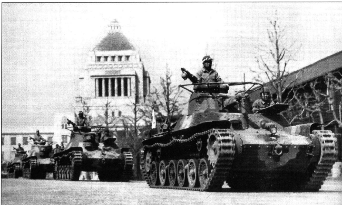
Средние танки «тип 97 Чи-ха» на улице захваченного Сингапура, 15 февраля 1942 г. Обратите внимание на эмблему японской армии - золотую пятиконечную звезду, закрепленную на верхнем лобовом бронелисте корпуса перед фарой.
