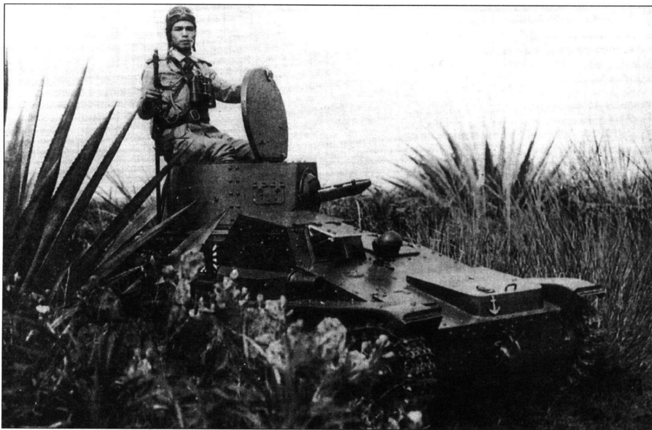
Подразделения Рикусентай имели собственную бронетехнику - танкетки «Чи-ро» и бронеавтомобили «тип 2592». В период войны на Тихом океане основным типом бронетехники морской пехоты являлась танкетка «тип 94» (на снимке). Обратите внимание на маркировку машины - якорек амфибийный подразделений в лобовой части корпуса и изображение военно-морского флага на борту корпуса.
